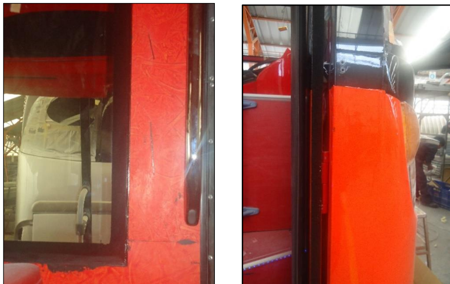
Fig. 26. Manchas de sikaflex en el interior y exterior de la carrocería
