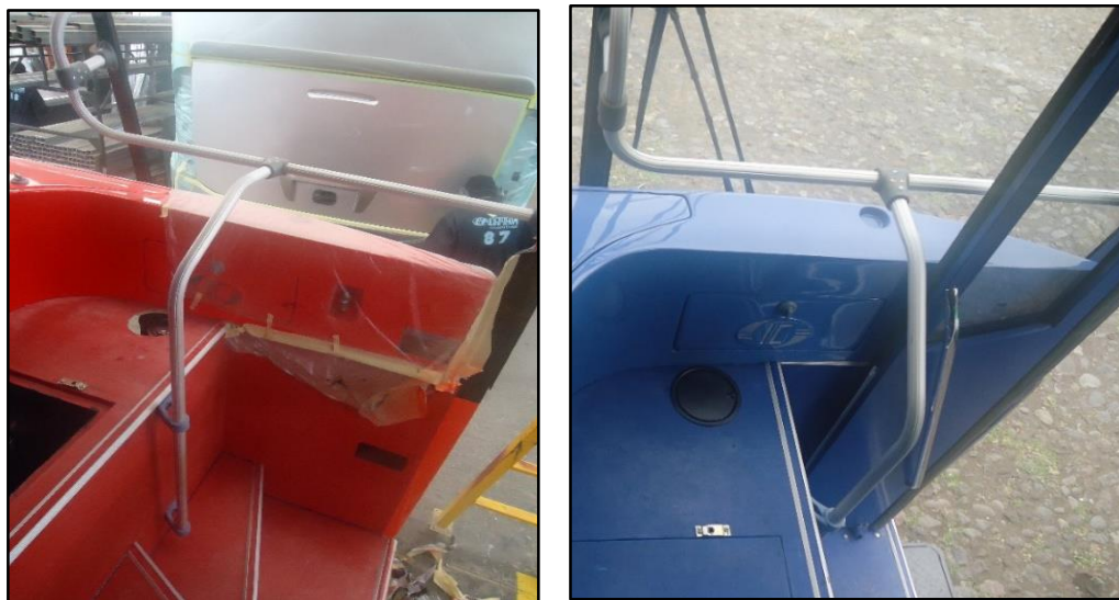
Fig. 51. Colores inadecuados en soportes de tubos de pasamanos, techo y laderas
