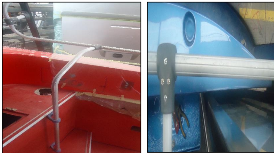
Fig. 42. Rayaduras en tubos de pasamanos, techo y laderas
