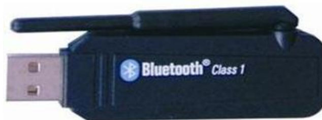
Figura 2. 3: Ejemplo de receptor Bluetooth, genérico con conector USB [4]
