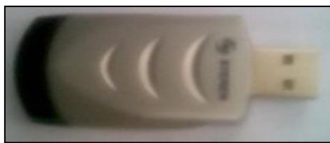
Figura 2. 2: Ejemplo de receptor infrarrojo, con conector USB " [4]
