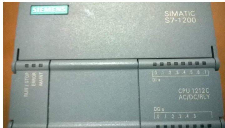
Fig.07. Plc SIMATIC S7-1200. Fuente Kleber Romero.
