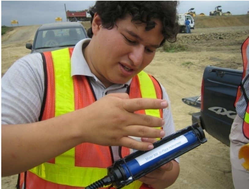
Foto 12.- Lubricación de guías de los inclinómetros y tubería.
