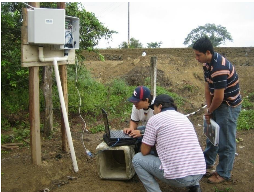
Foto 19.- Transferencia de datos a PC luego de 8 días de funcionamiento.
