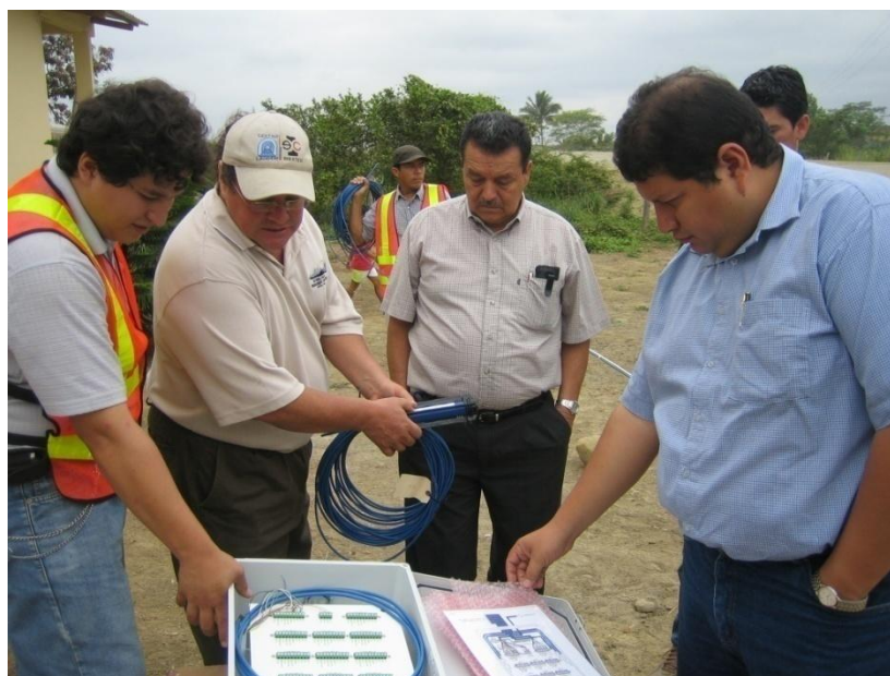
Foto 15.- Verificación de la posición interna de los inclinómetros y códigos de los equipos.
