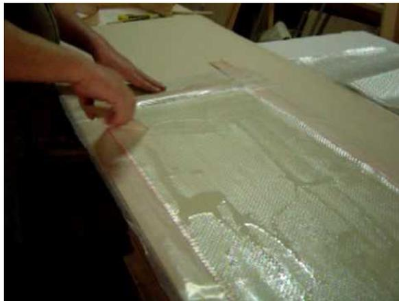
**Figura 6-9.** Laminado de un material compuesto.
