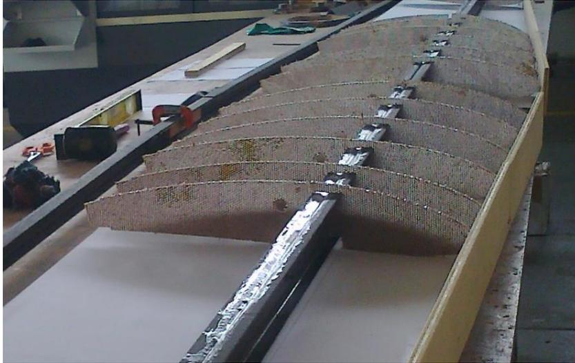
**Figura 6-13.** Viga principal de una estructura alar.
