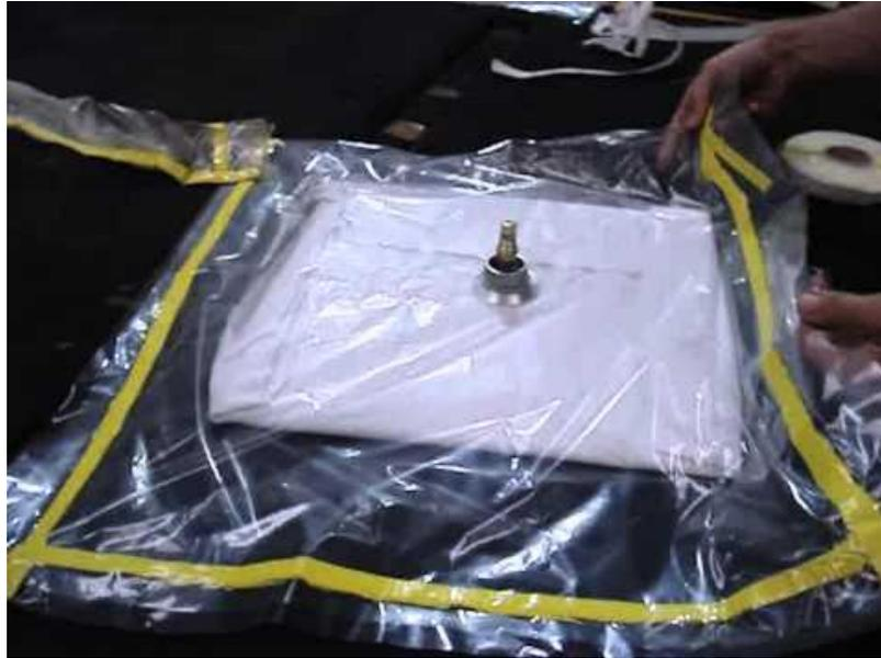
**Figura 6-10.** Vaciado de un material compuesto.
