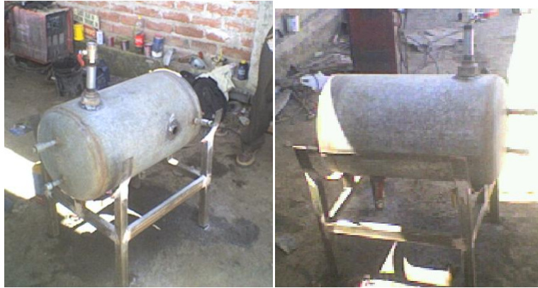
Base del tanque externo y tanque
