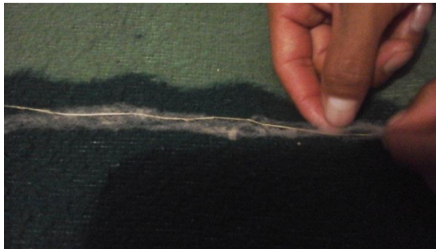
Gráfico 48: Mezcla de suro y lana para hilado aplicando torsión
