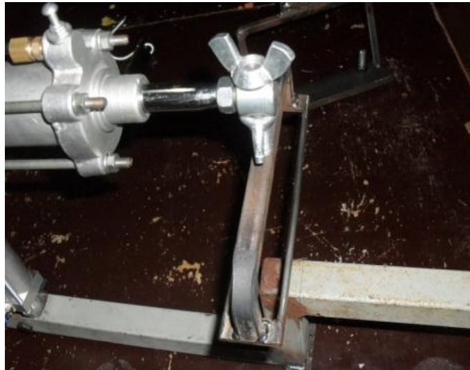
Figura 6.8: Colocación del soporte para racleta
