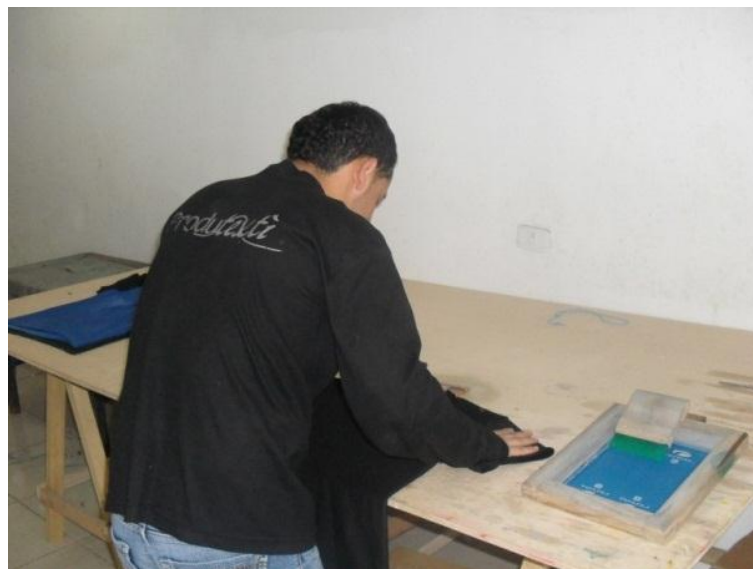
Figura 2.2: Aplicación de pintura sobre la malla
