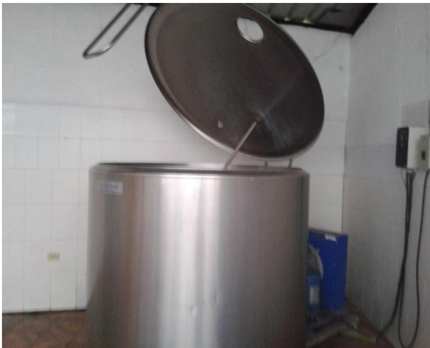
Calderos de almacenamiento y enfriamiento
