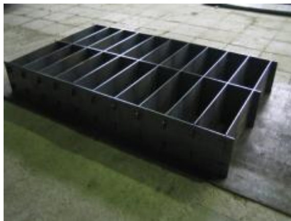
Gráfico N° 30. Moldes para bloques de 15 cm macizo
