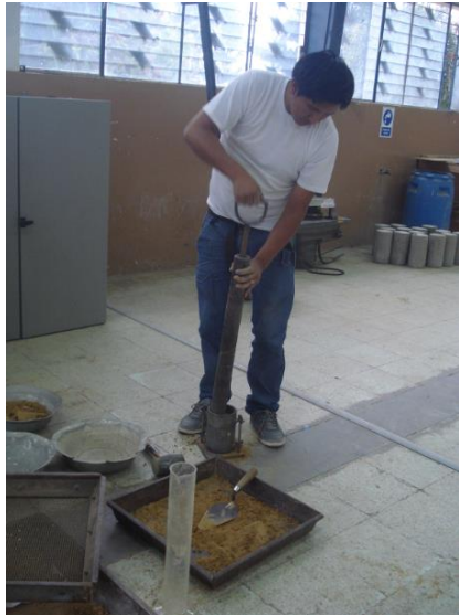
Nº7: Ensayo de compactación y C.B.R.
