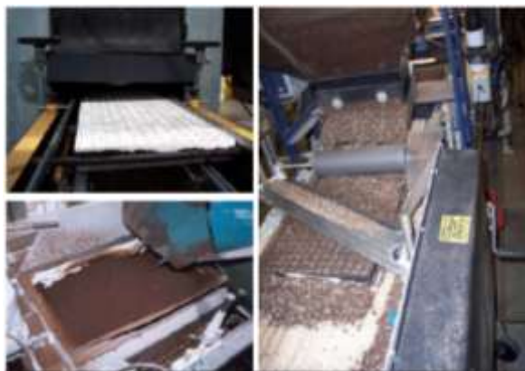
Figura N°2. 20: Llenado de bandejas automático o mecanizado – tres diferentes equipos para esta labor.
