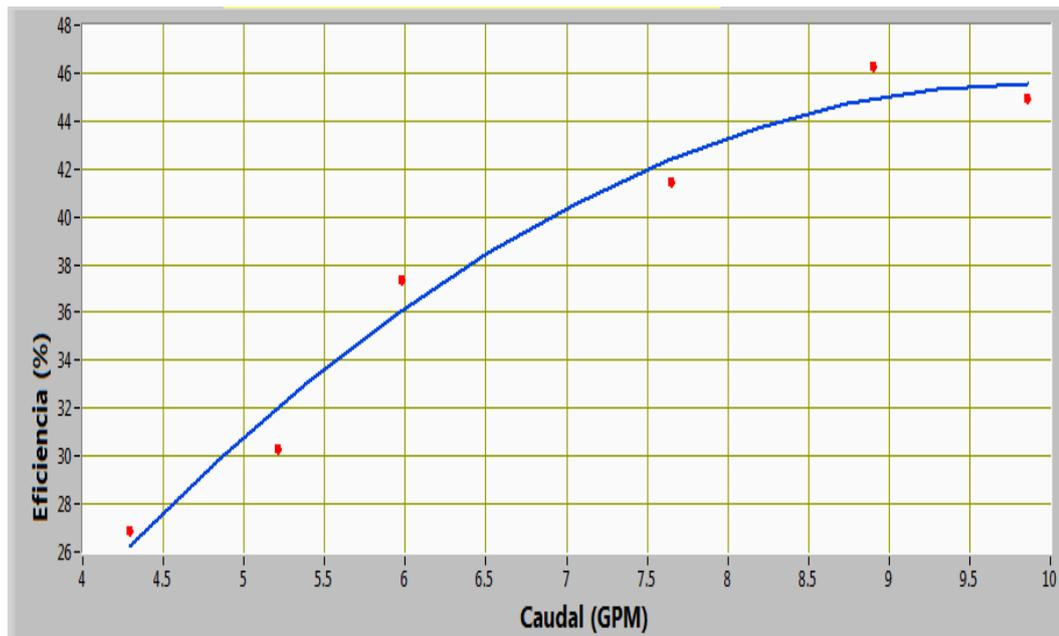
**Figura 4-41** Representación gráfica del Caudal con respecto a la Eficiencia
