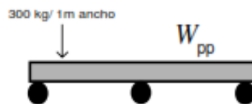
Gráfico VI.2.D Verificación de esfuerzos admisibles por carga puntual (300 Kg)
