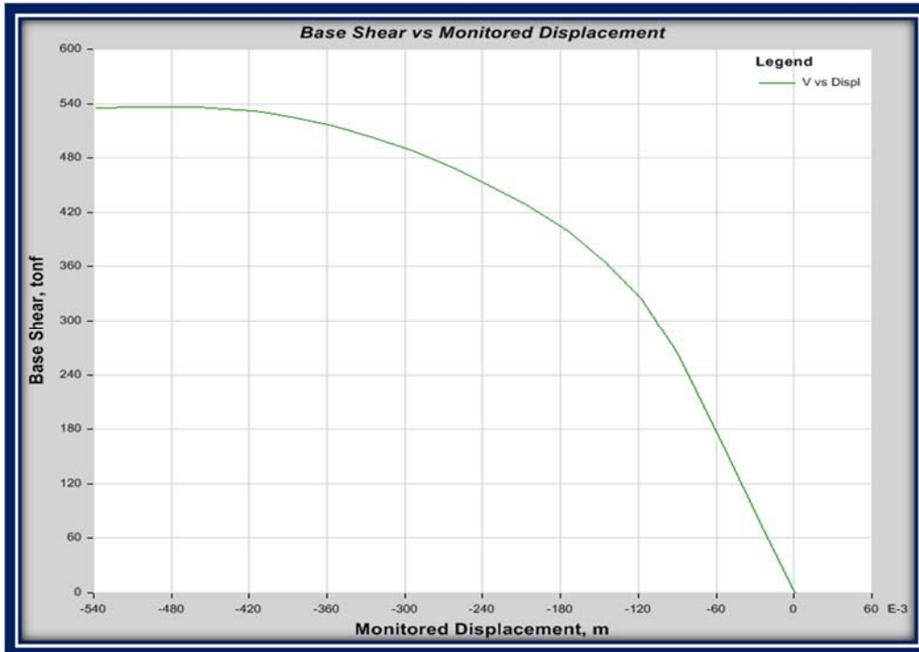
Gráfico VI.187 Curva de capacidad para el caso de carga PUSHOVER-CL-1MX sin incluir efecto P-delta Fuente: (Captura de Software Especializado)
