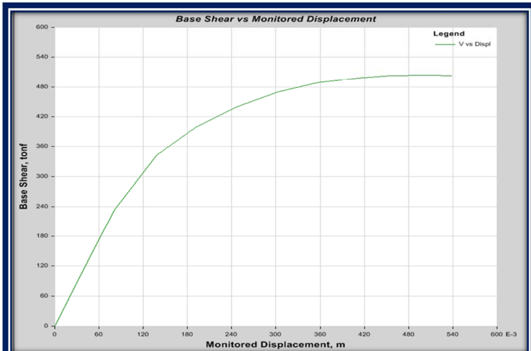
Gráfico VI.185 Curva de capacidad para el caso de carga PUSHOVER-CL-X sin incluir efecto P-delta Fuente: (Captura de Software Especializado)
