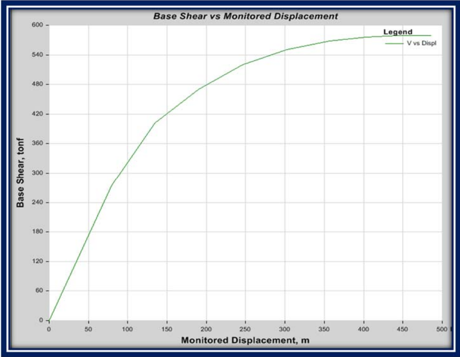
Gráfico VI.189 Curva de capacidad para el caso de carga PUSHOVER-CL-U-X sin incluir efecto P-delta Fuente: (Captura de Software Especializado)
