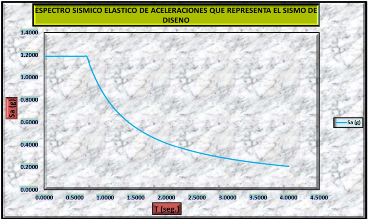
Gráfico VI.9 Espectro sísmico elástico de aceleraciones que representa el sismo de diseño
