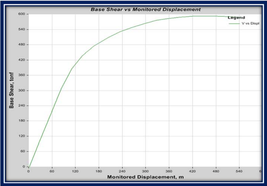
Gráfico VI.190 Curva de capacidad para el caso de carga PUSHOVER-CL-U-Y sin incluir efecto P-delta Fuente: (Captura de Software Especializado)
