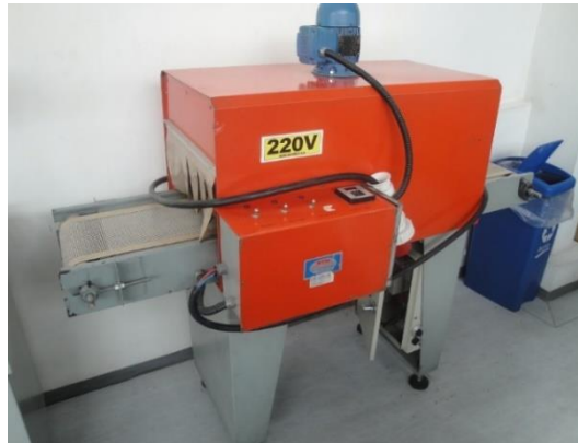
Figura 20. Túnel de termo encogido
