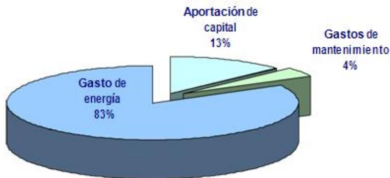
Gráfico VI.12: Costos en una instalación de aire comprimido
