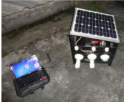
Fig. 4.46 Conexión de los dos focos de 20W y portátil Fuente: Autor
