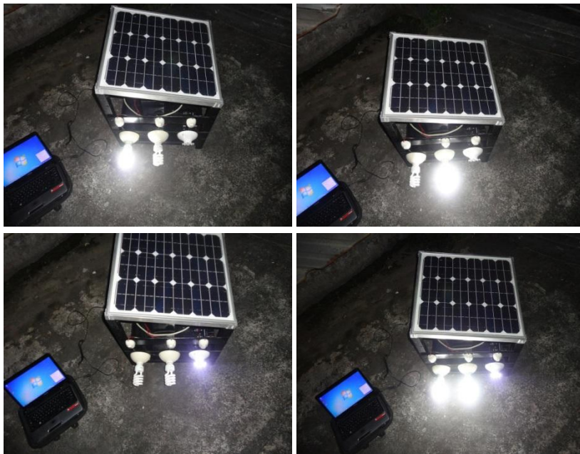
Fig. 4.49 Pruebas de funcionamiento de cada uno de los focos Fuente: Autor
