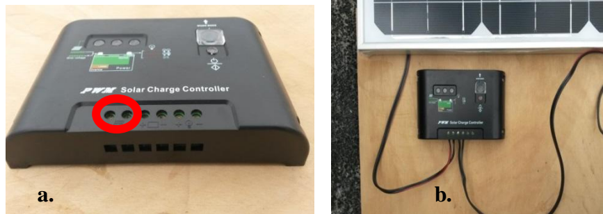
Fig. 4.36 a) Entradas de conexión para panel en el regulador b) Conexión panel – regulador Fuente: Autor
