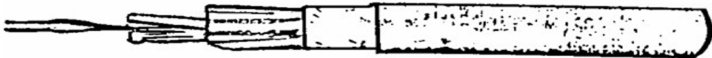
Figura 2.7. Cable constituido por conductores de cobre aislados con PVC y con cubierta exterior de PVC,
