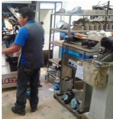
Figura 35. Vaporizado de cortes preparados
