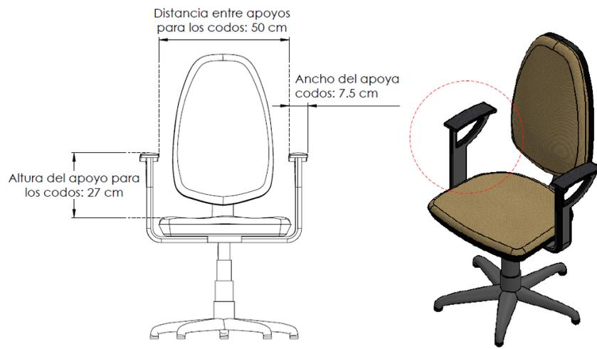
**Figura 129.** Dimensiones del apoyo para los codos
