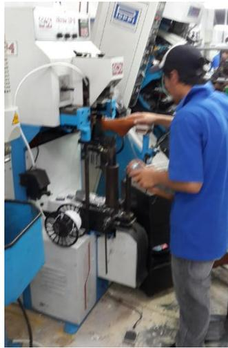
Figura 41. Armado de talones
