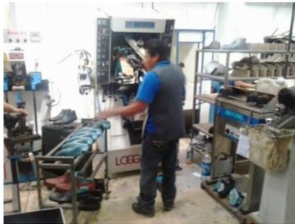
Figura 36. Armado de puntas
