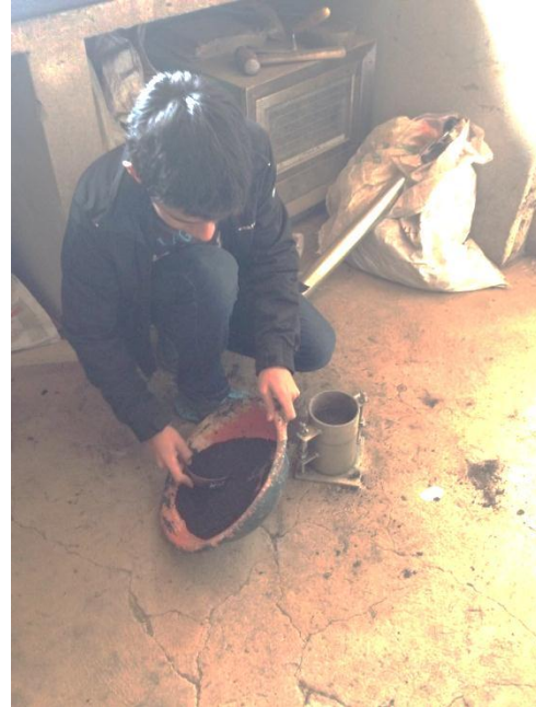
Ilustración 78: Colocación de Capas
