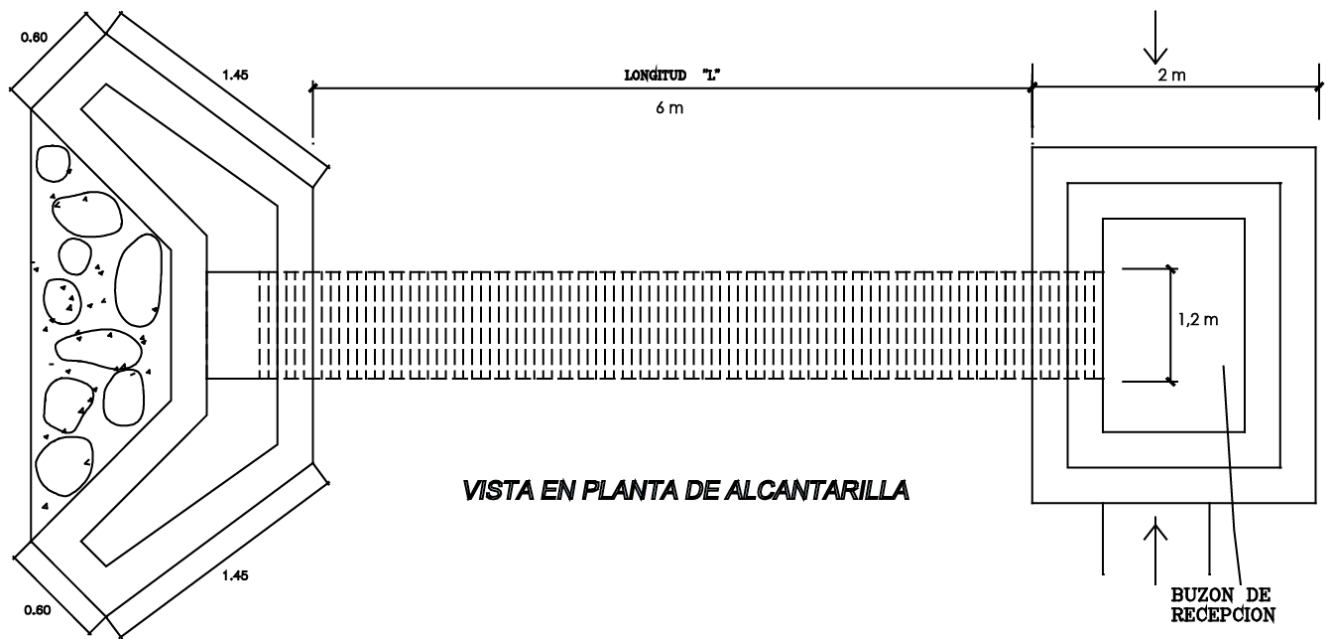
Ilustración 41 Vista en planta Alcantarillado
