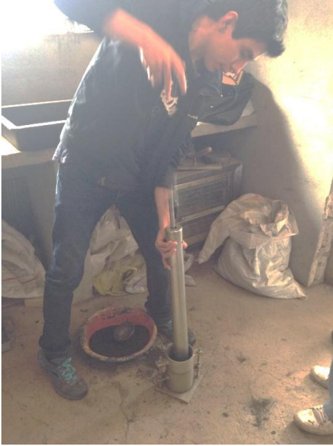
Ilustración 77: Compactación con el Martillo
