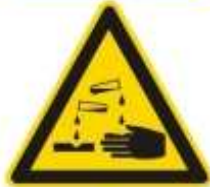
Advertencia de sustancias corrosivas
