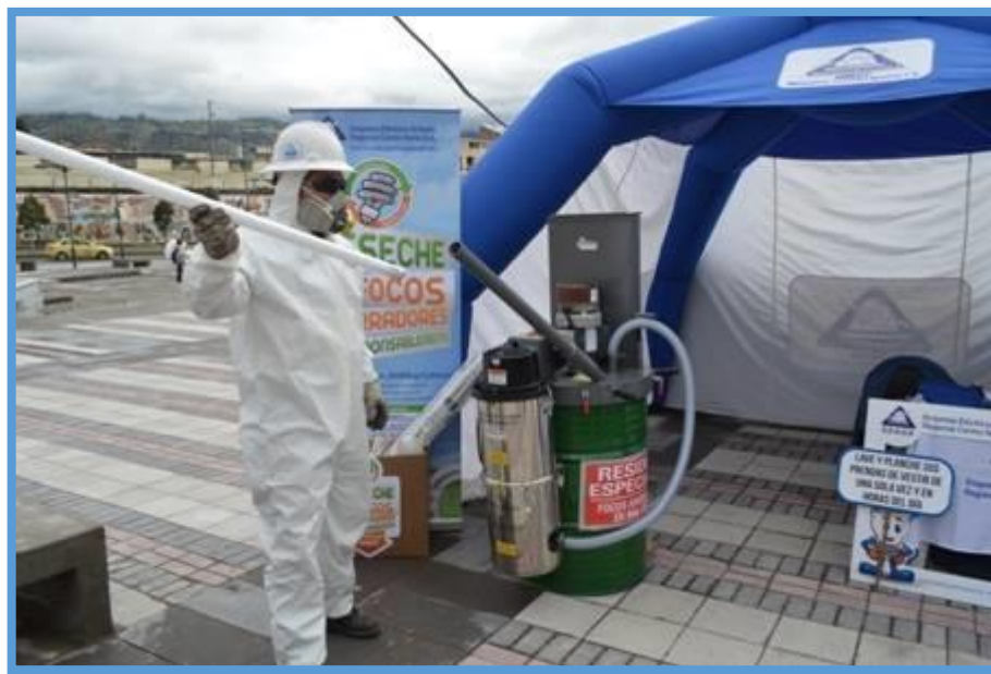
Fotografía Máquina compactadora de lámparas y sistema de recuperación de vapores de mercurio Fuente: Empresa Eléctrica Ambato Regional Centro Norte S.A.
