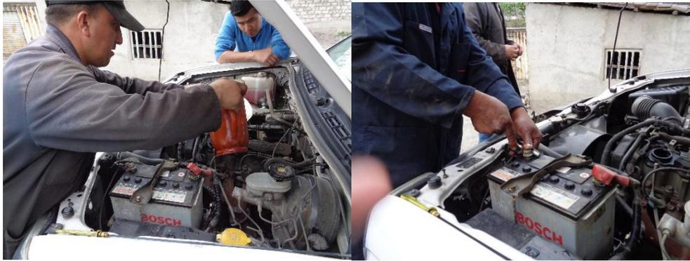
Fig 15. “Cambio de batería”
