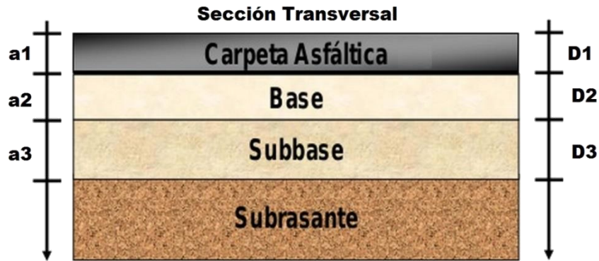
Gráfico N. 42 Estructura esquemática para pavimento flexible
