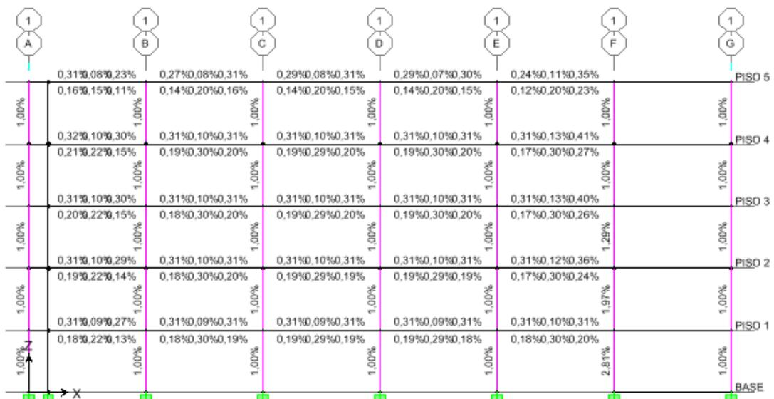
Figura N° 6.88 Porcentajes de Acero en Columnas
