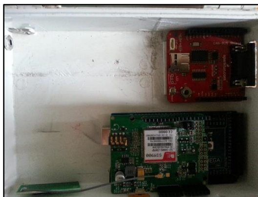
Fig. 4.36 Colocación de los módulos Arduino Mega 2560 y GSM/GPRS SIM900
