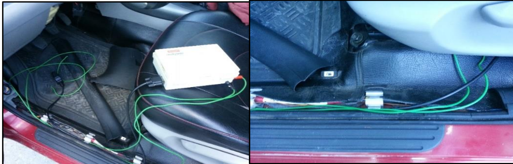
Fig. 4.42 Ubicación del chasis bajo el asiento del conductor Elaborado por: David Chávez
