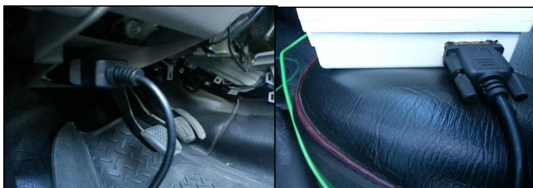
Fig. 4.19 Conectar el vehículo y el módulo CANBUS a través del cable OBD2 Elaborado por: David Chávez
