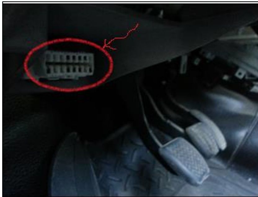
Fig. 4.25 Ubicación del puerto de comunicación del puerto OBD2 dentro del vehículo Elaborado por: David Chávez
