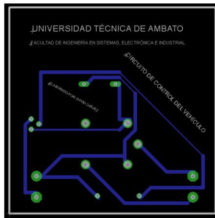
Fig. 4.10 Diagrama de pistas de la placa circuito de control Elaborado por: David Chávez
