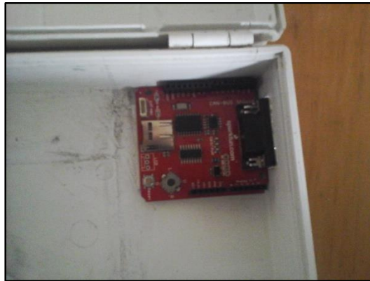
Fig. 4.35 Colocación del módulo CANBUS
