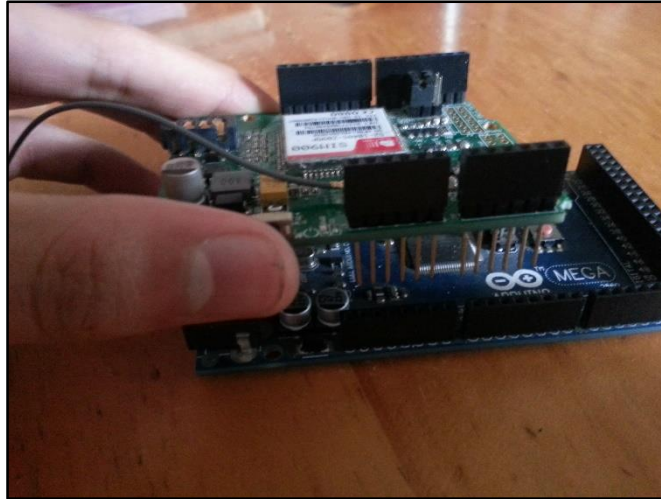
Fig. 4.14 Conexión física entre el módulo GSM/GPRS y el Arduino MEGA 2560
