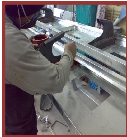
Retirar canastillas acopladas y hacer agujeros para luces individuales
