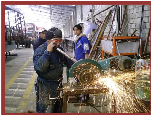
Esmerilizar la estructura de guarda choque con pieza de fibra de vidrio de la misma.
