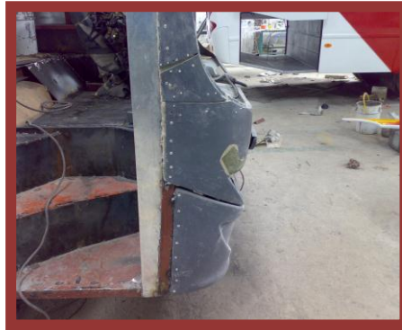
Construcción de estructura de guarda choques.
