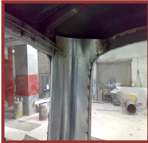
Acople de plancha de 1/32 Pulg. En laterales posteriores
