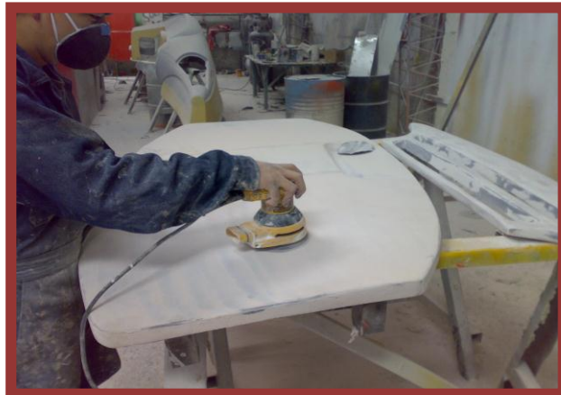
Lijar con vibradora y lija N° 400.
