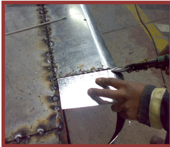
Soldar pedazos de plancha 1/16 Pulg. En todo el tapa máquina
