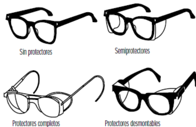
GRÁFICO No.3: Tipos de gafas de protección ocular, con y sin protectores laterales
