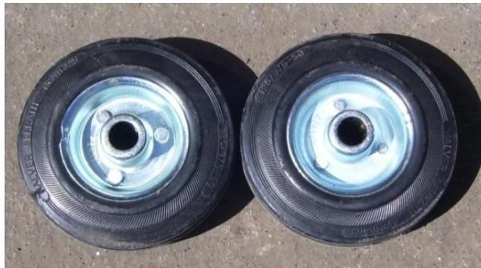
**Fig. N° 6.12**Ruedas de caucho soporte delantero
