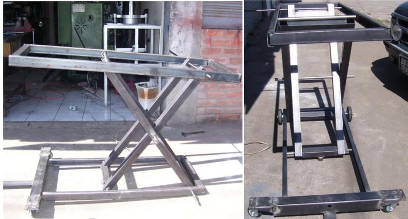
**Fig. N° 6.17** Acople de la base guía superior con la estructura X.
