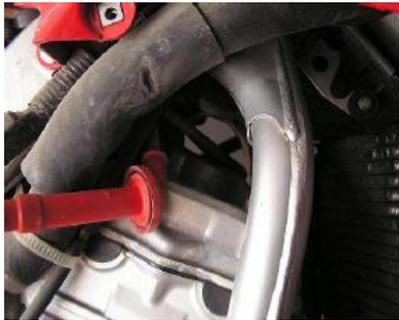
**Fig. 2.11. Cambio de bujías**
