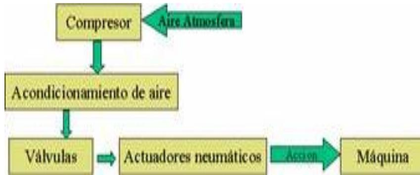
**Fig. 2.2. Sistema de aire comprimido**
