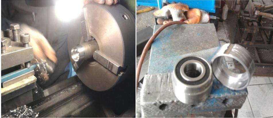
**Fig. N° 6.14**Mecanizado de bocín para eje móvil
