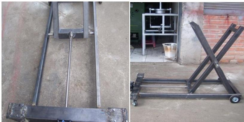
**Fig. N° 6.16**Acople pistón con el mecanismo de elevación
