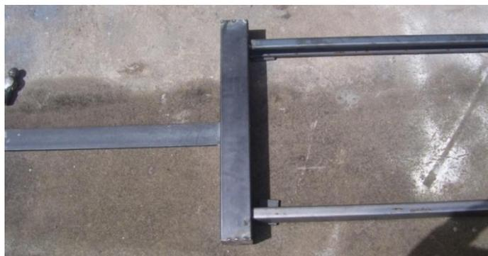
**Fig. N° 6.10** Unión soporte pistón y base guía inferior
