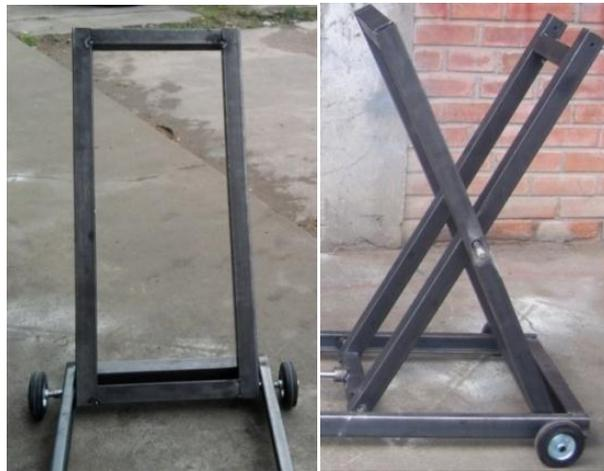
**Fig. N° 6.15**Ensamble mecanismo de elevación en X
