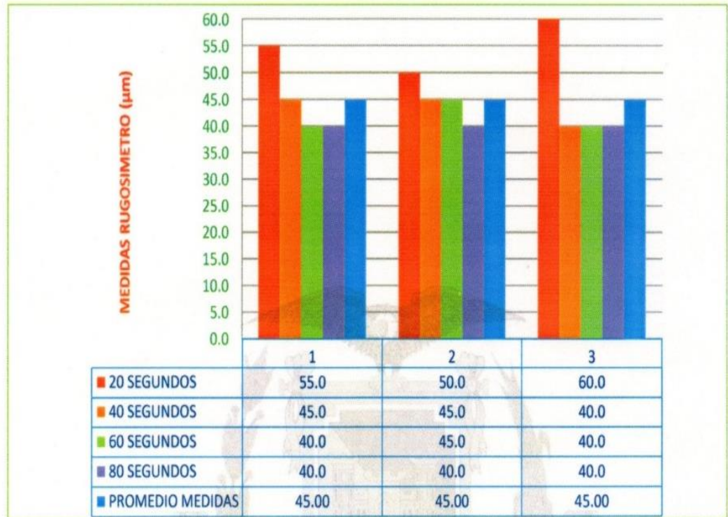
GRAFICO MEDIDAS RUGOSIDAD CUERO PLANCHADO A TEMPERATURA DE 25° C VS NUMERO DE MEDIDAS REALIZADAS
