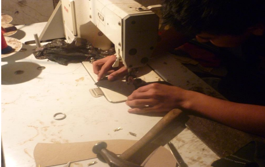
Figura 5 aparado o cosido del corte [Fuente elaborado por el autor]
