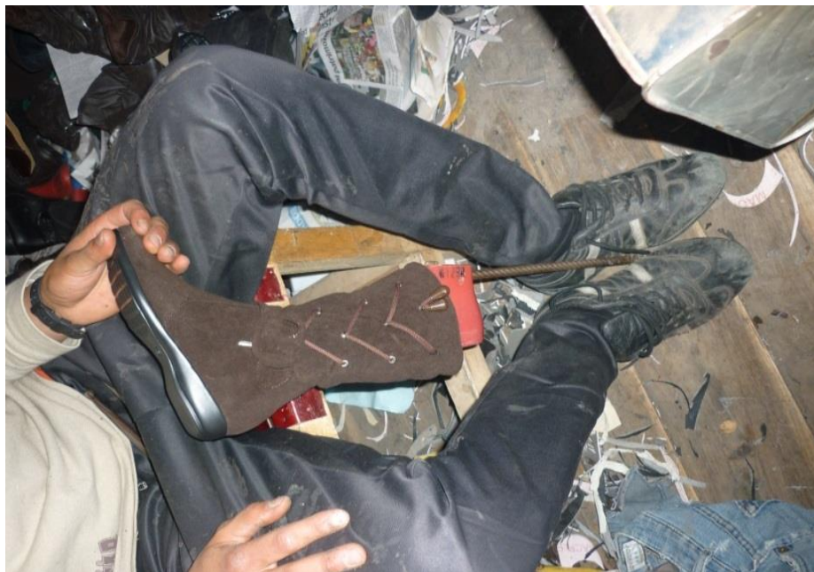
Figura 9 sacado de hormas o desmonte [Fuente elaborado por el autor]
