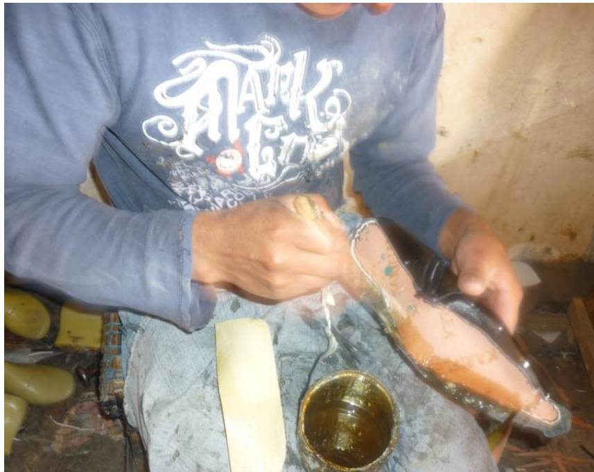
Figura 7 Pegado de las partes y punteras [Fuente elaborado por el autor]
