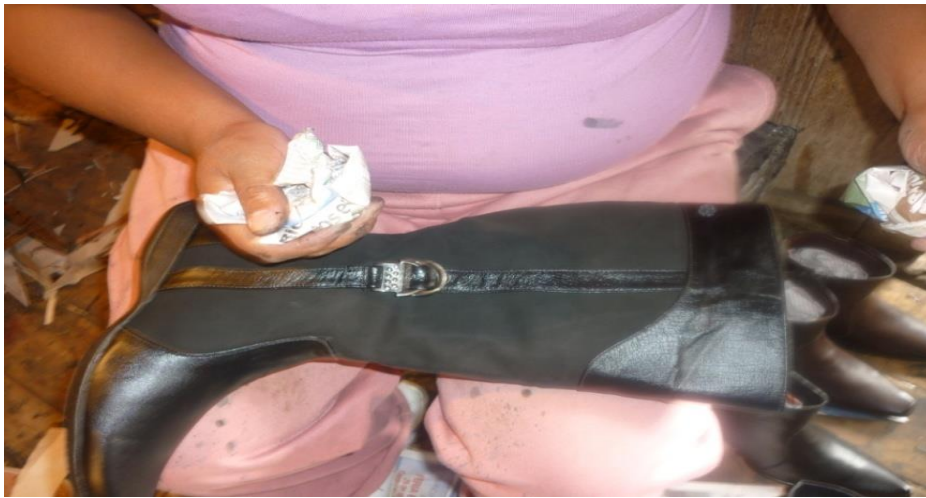
Figura 10 Empapelado de la bota [Fuente elaborado por el autor]
