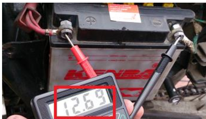
Figura 4.26: Tensión nominal de la batería con el motor apagado Fuente: El Investigador.
