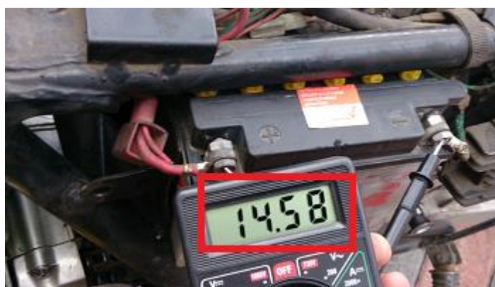
Figura 4.27: Tensión nominal de la batería con el motor encendido Fuente: El Investigador.
