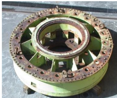
Figura 2.5 Tapa Superior de la Turbina que Necesita Reparación (HIDROAGOYÁN)
