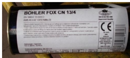
Figura 2.10 Material de aporte utilizado en los procesos de soldadura de las partes de las turbinas (HIDROAGOYÁN)
