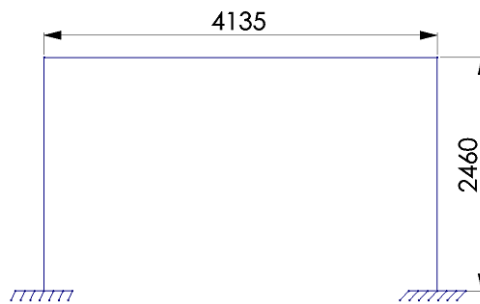
Figura 6.19 Pórtico principal de la Estructura del Horno (Carlos Fernando Sánchez R.)
