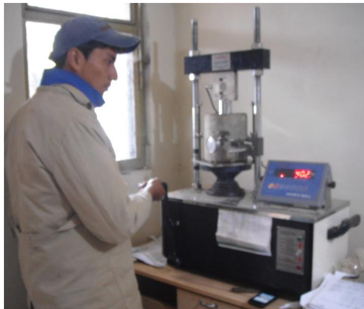
Gráfico N° 40. Realizando el ensayo de Penetración.
