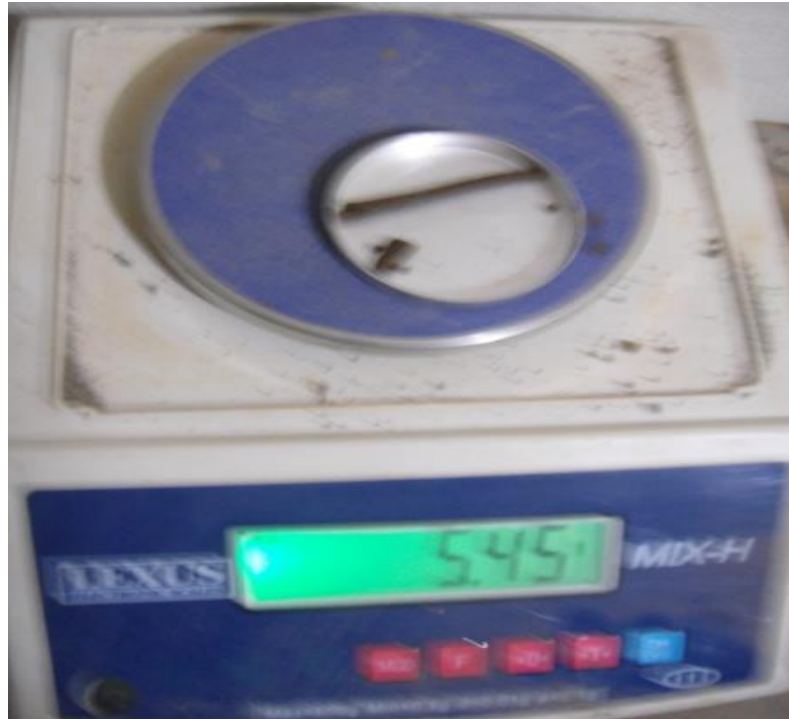
Gráfico N° 37. Pesando muestra Suelo húmedo + recipiente, balanza sensibilidad \pm 0.01 g
