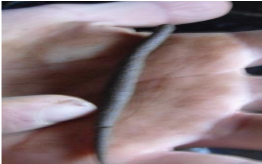
Gráfico N° 36. Muestra para determinar el límite plástico del suelo
