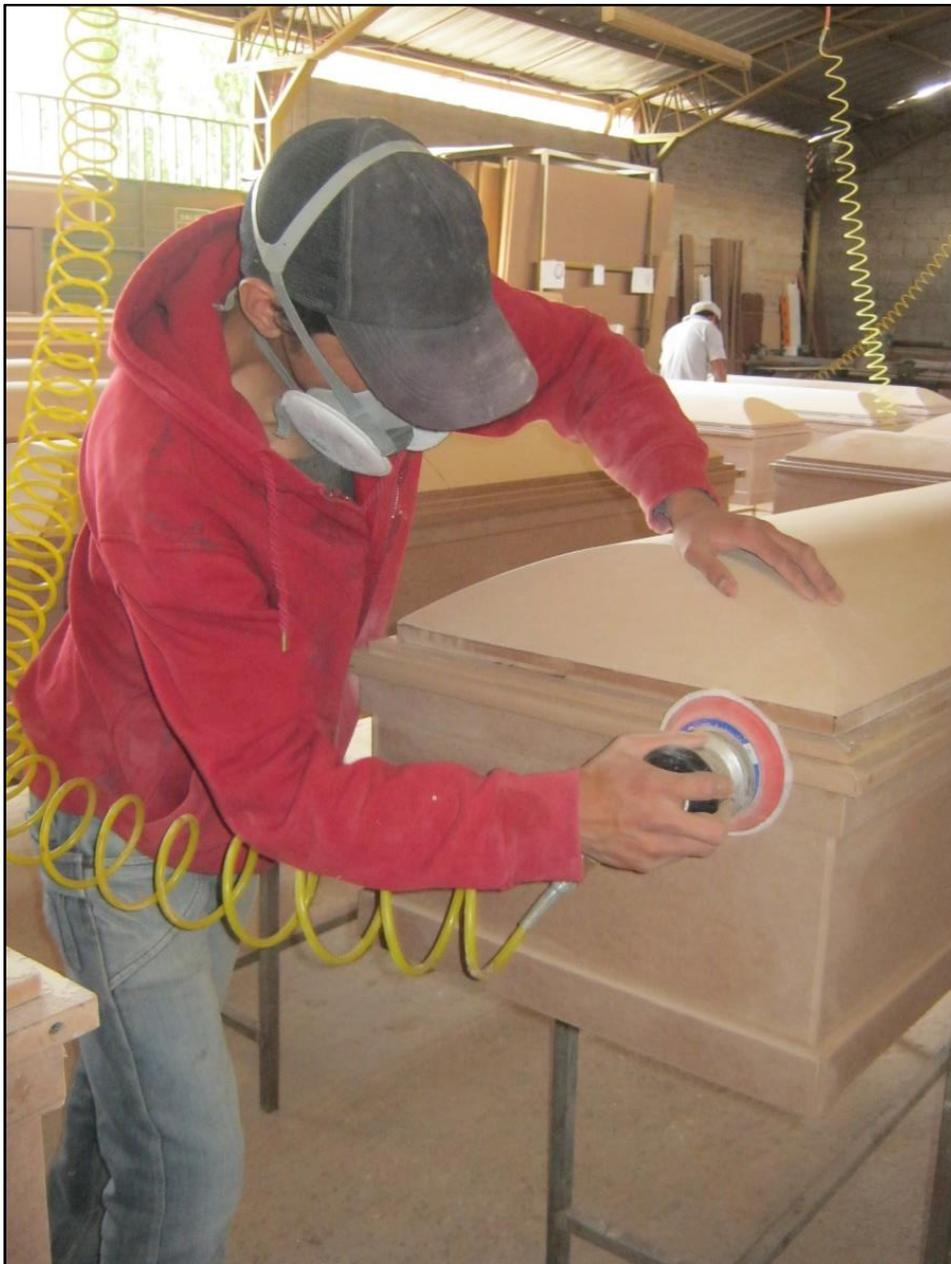
Figura 3: Preparación de la superficie de la madera a ser pintada
