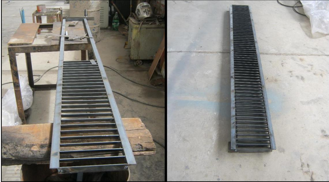
Figura 78: Rejillas para las fosas de la cámara de pintura.
