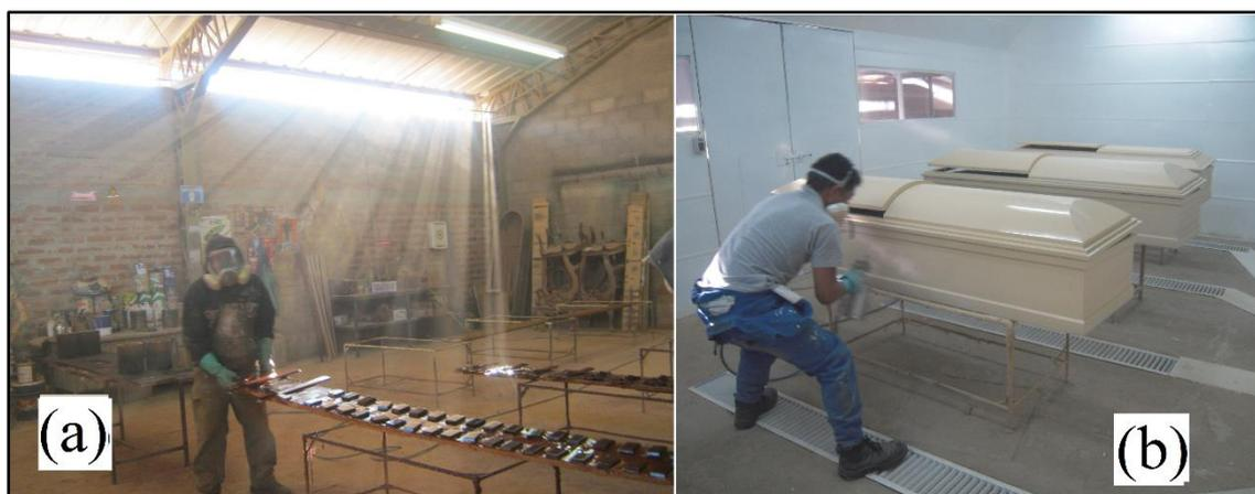
Figura 92: Comparación de ventilación de partículas de pintura
