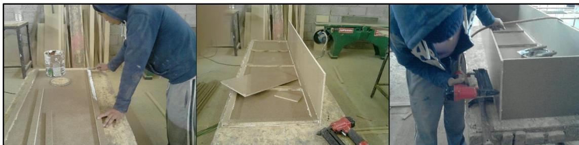
Figura 18: Ensamble cajón
