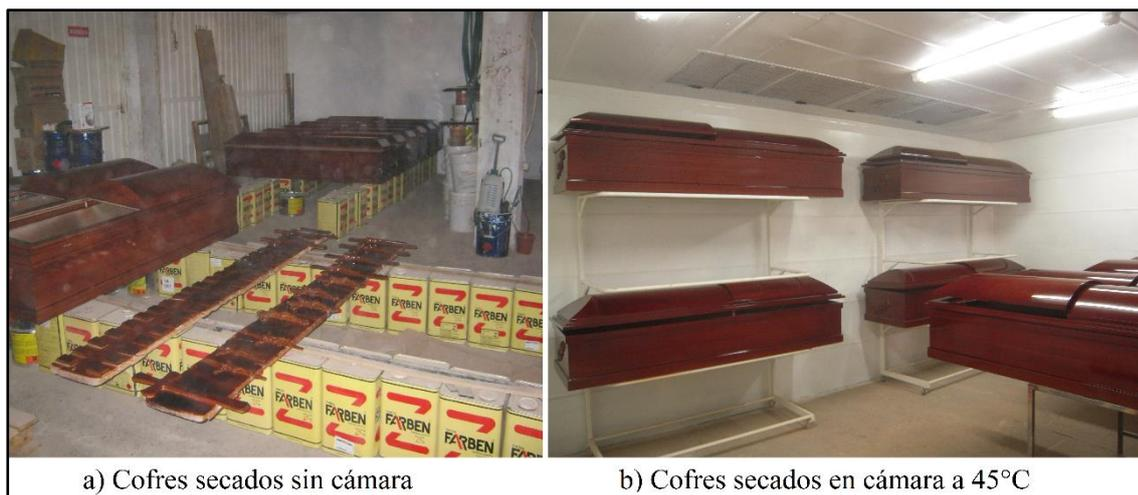
Figura 91: Comparación de secado de cofres mortuorios.
