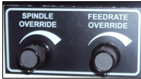
Figura 17: Potenciómetros de la maquina CNC. Fuente: Jesús Rodríguez
