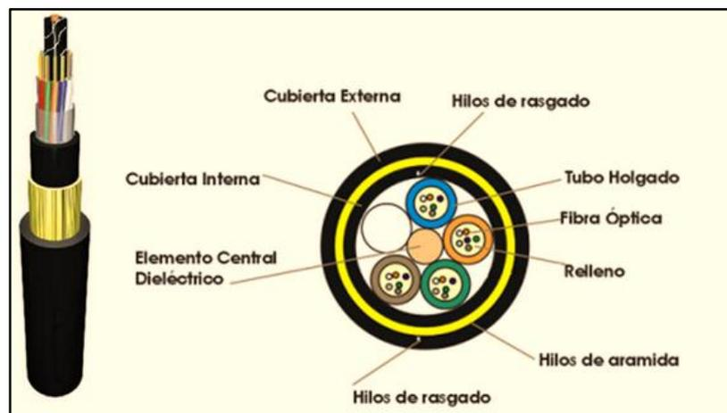
**Figura 2.2.-** Componentes de la Fibra óptica
