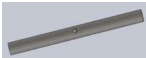
Figura 6.2: Eje Conducido Acero AISI 1020
