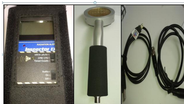
Figura 4-2 Equipo Inspector EXP y sus componentes.
