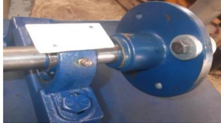
**Figura 6.43** Disco colocado masa
