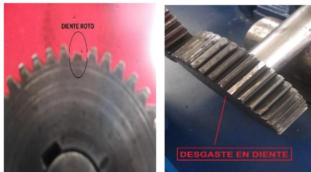
*Figura 6.51 Engrane desgastado y roto*
