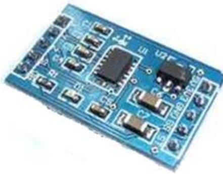
**Figura 2.4** Acelerómetro
