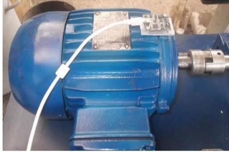
**Figura 6.47** Conexión sensor de aceleración
