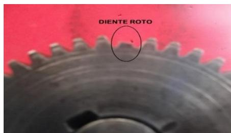
*Figura 4.8 Engrane conducido roto un diente*
