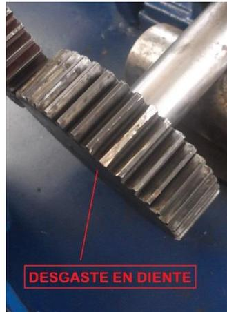
*Figura 4.7 Engrane conducido desgastado*
