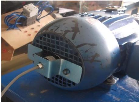
**Figura 6.48** Conexión encoder
