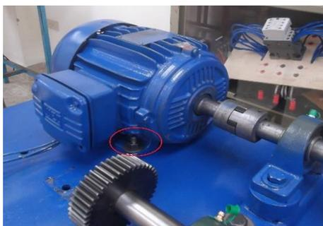
*Figura 6.41 Verificar el ajuste del motor*
