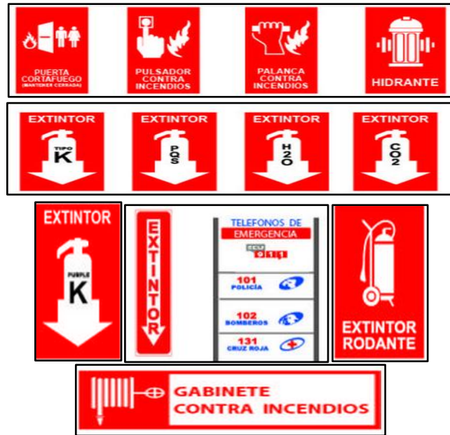
Fig. 24 Señales de lucha contra incendios [73]
