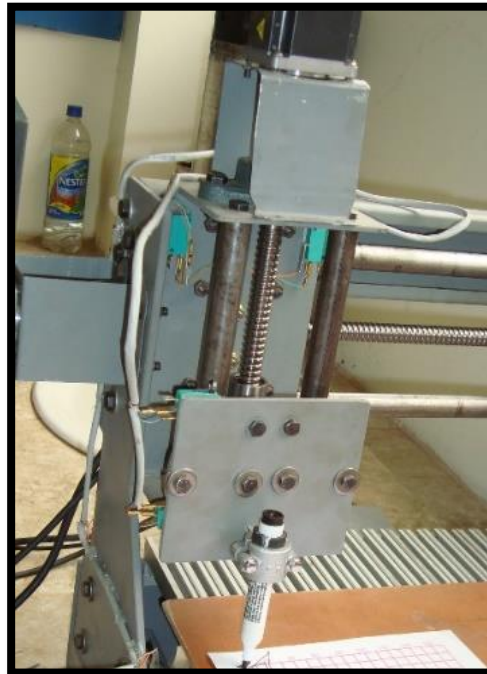
Figura 4.2: Movimiento de arriba hacia abajo del eje Z.
