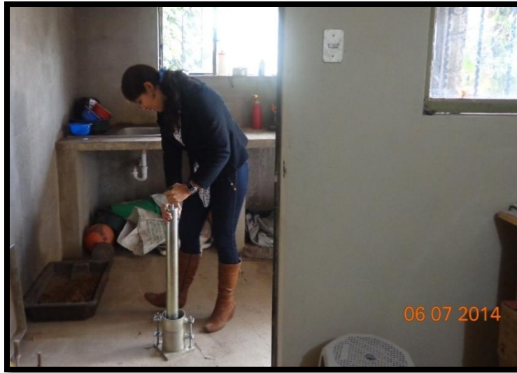
Realizando ensayo de Compactación
