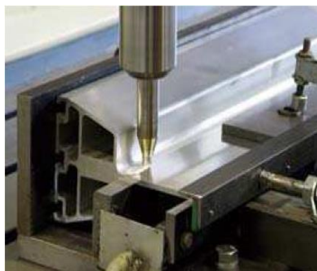
Figura 2.21 Reparaciones de fisuras en estructuras de plataformas
