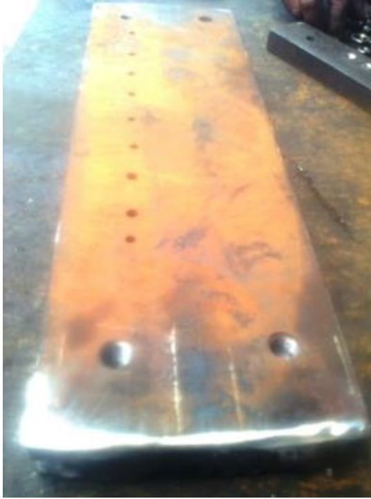
Figura B.7 Placa base construida (Fuente: El autor)
