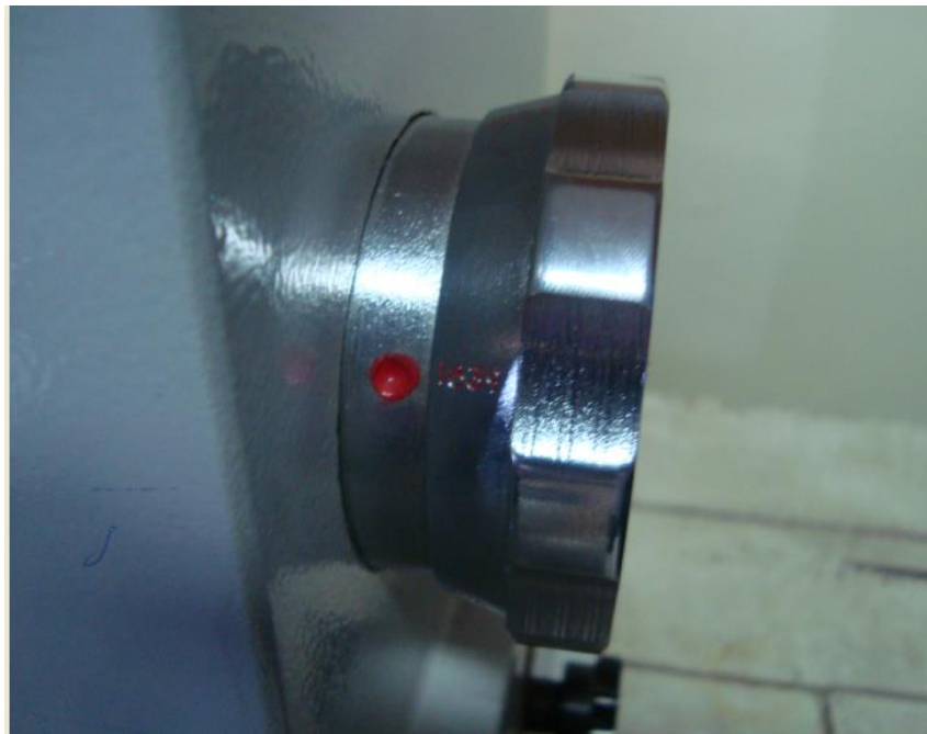
Figura A.18 Calibración de la carga del durómetro en 1839N (Fuente: El autor)
