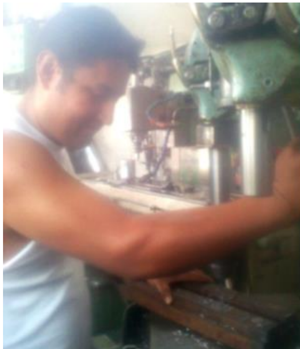
Figura B.4 Taladrado de la placa base (Fuente: El autor)
