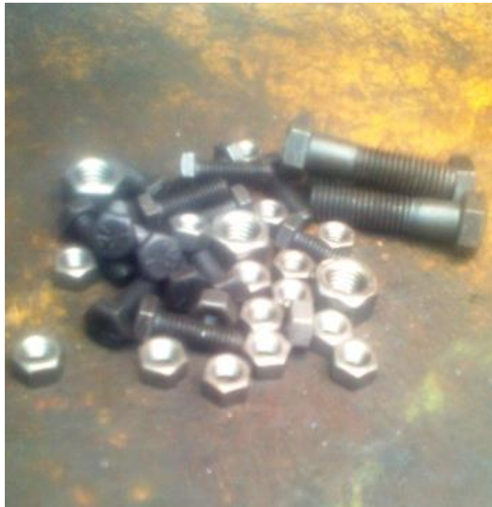
Figura B.8 Pernos de 1/2in para la placa base y de 1/4in para los sujetadores (Fuente: El autor)
