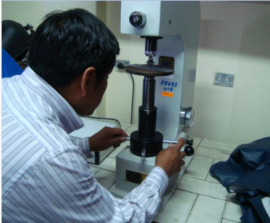
Figura A.19 Contacto entre el penetrador con la probeta (Fuente: El autor)
