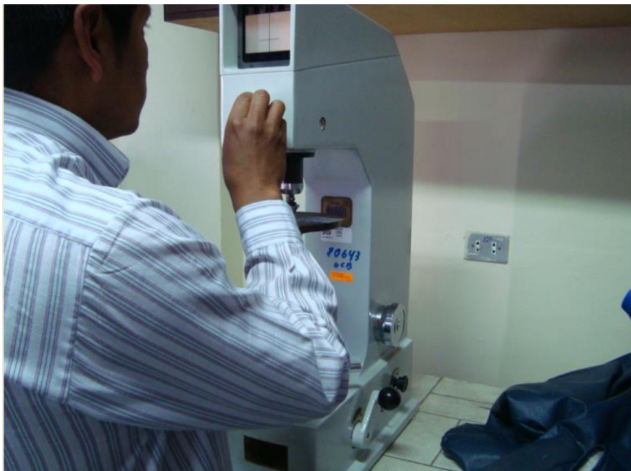
Figura A.20 Regulación de la precarga hasta el nivel 100 (Fuente: El autor)
