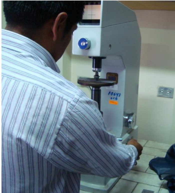
Figura A.21 Aplicación de la precarga sobre la probeta (Fuente: El autor)
