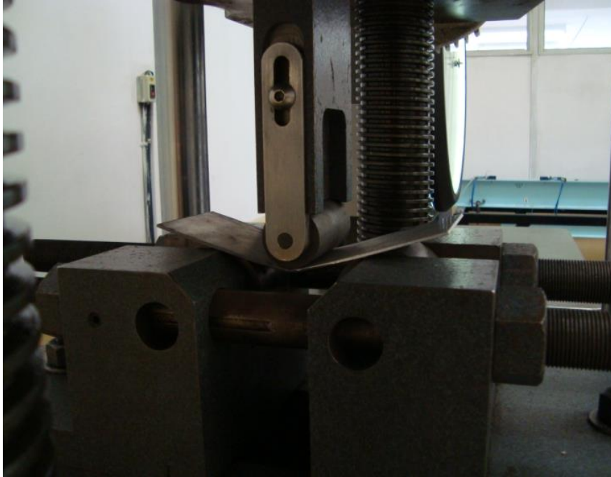
Figura A.11 Aplicación de la carga gradualmente sobre la probeta (Fuente: El autor)
