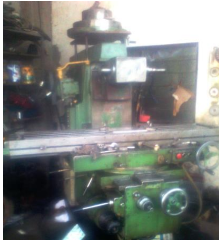
Figura 4.2 Fresadora adaptada al proceso FSW
