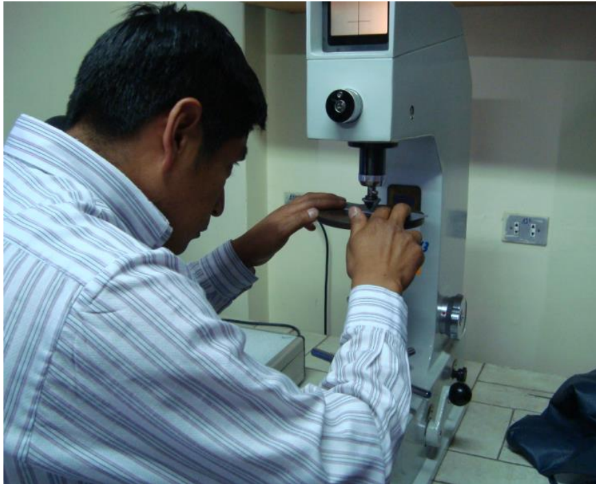
Figura A.17 Colocación de la probeta sobre la base del durómetro (Fuente: El autor)
