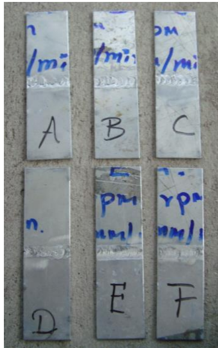
Figura A.7 Probetas para el ensayo de doblado de soldadura
