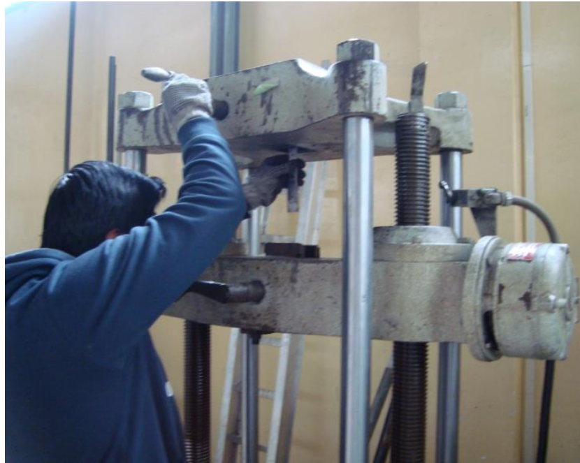
Figura A.3 Colocación de la probeta en las mordazas de la Máquina Universal de Ensayos (Fuente: El autor)
