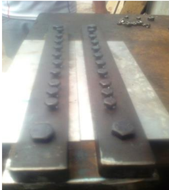
Figura B.12 Fijación de las placas de aluminio para soldar (Fuente: El autor)
