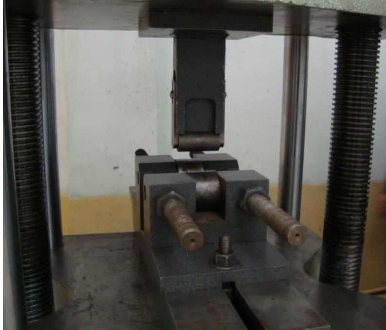
Figura A.9 Método de doblado guiado mediante enrollado (Fuente: El autor)
