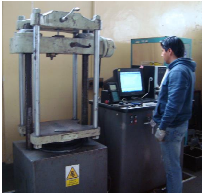
Figura A.4 Ejecución del programa para la aplicación de la carga a la probeta (Fuente: El autor)
