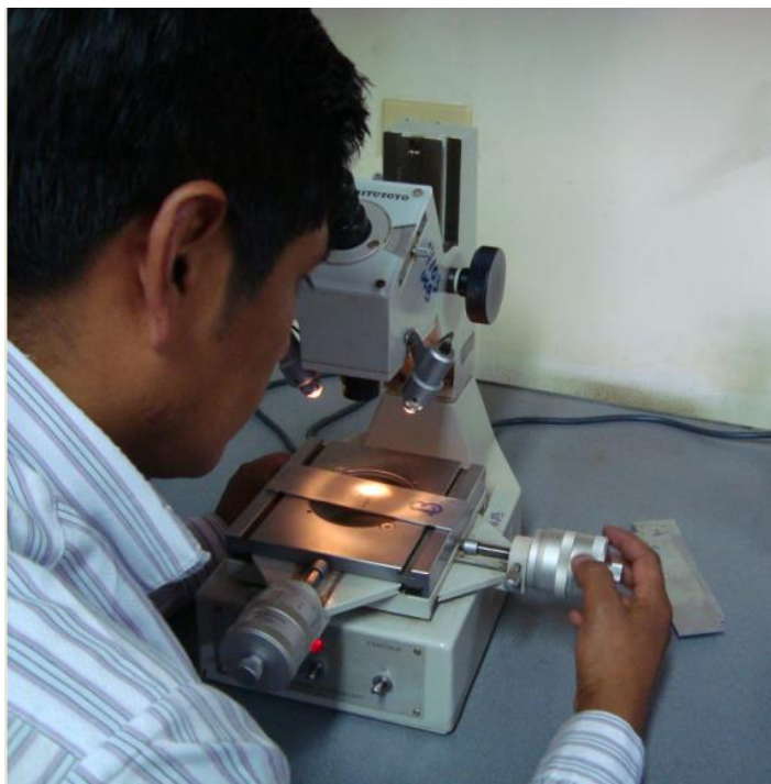
Figura A.22 Observación del diámetro de la huella en el microscopio (Fuente: El autor)
