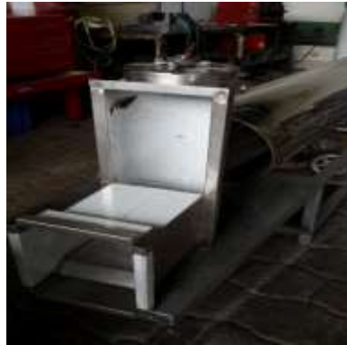
Canal del tornillo helicoidal
