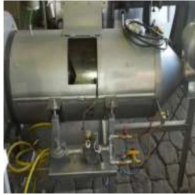
Cámara del quemador
