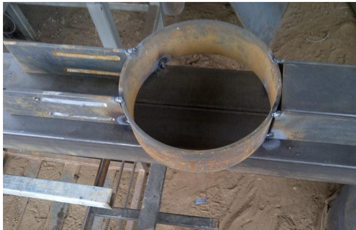
Figura 6.10: Construcción del soporte del rodillo FUENTE: Roberto C. Panimboza C. (Autor)
