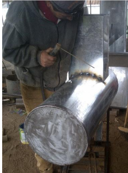
Figura 6.8: Construcción del depósito. FUENTE: Roberto C. Panimboza C. (Autor)
