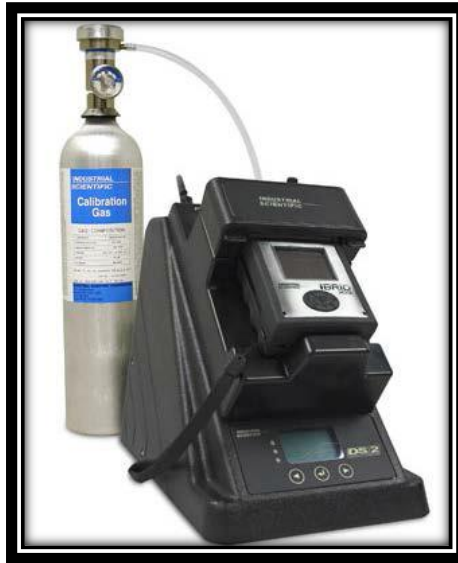
Figura 4.1: Medidor de Compuestos orgánicos Volátiles IBRID MX 6 Fuente: Informe CEPOLFI
