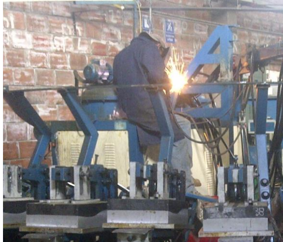
Figura 6.13: Ensamble del soporte del brazo. FUENTE: Roberto C. Panimboza C. (Autor)
