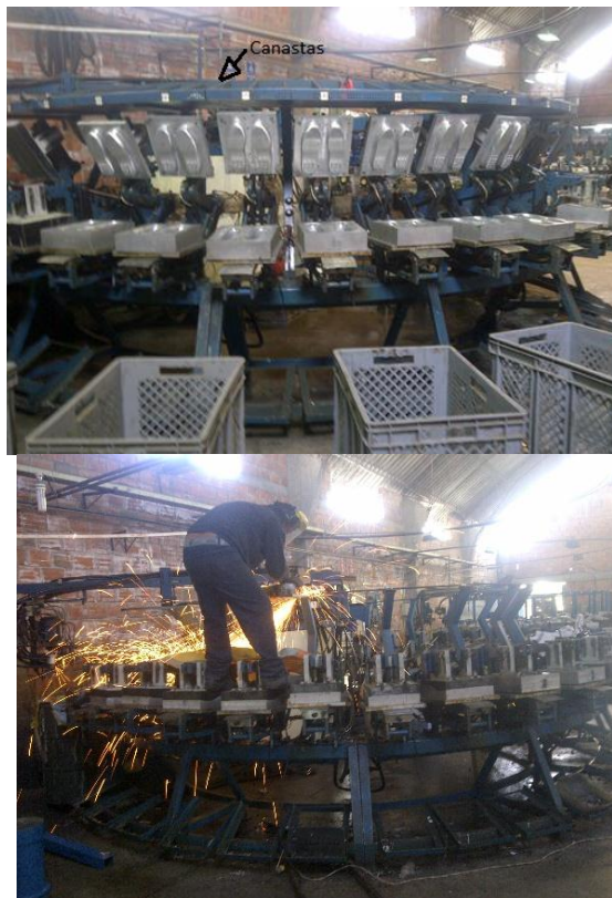
Figura 6.12: Cortar las canastillas de la inyectora FUENTE: Roberto C. Panimboza C. (Autor)
