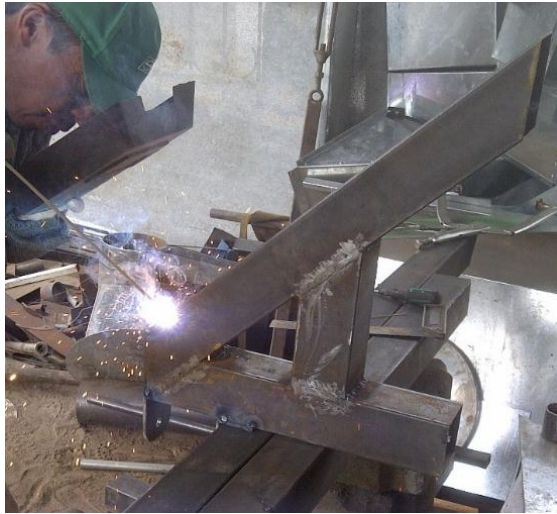
Figura 6.11: Construcción del soporte del brazo FUENTE: Roberto C. Panimboza C. (Autor)
