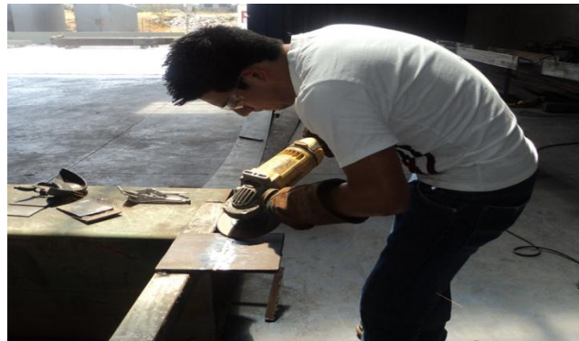
Figura 6. 12.- Pulido del cordón hasta el material base
