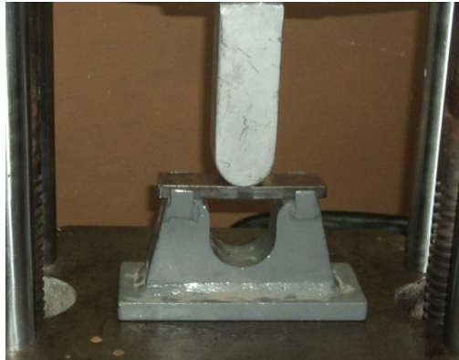
Figura 6. 40.- Colocación de la probeta para ensayo de dobles
