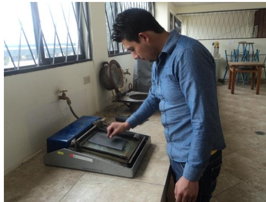
Figura 6. 47.- Lijado de la probeta
