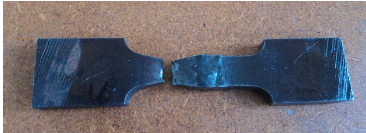
Figura 6. 20.- Probeta rota después del ensayo de tracción
