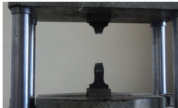
Figura 6. 19.- Probeta rota en el ensayo de tracción
