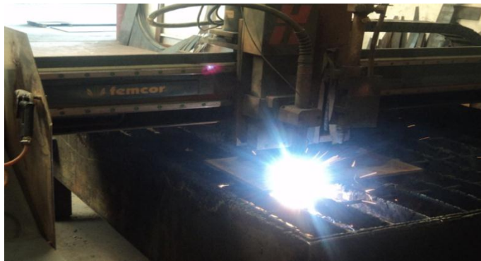
Figura 6. 14.- Corte por plasma CNC de probetas para el ensayo de tracción FUENTE: Alex Izurieta
