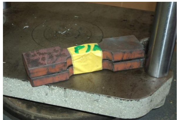
Figura 6. 15.- Probetas de 12 y 20 mm para el ensayo de tracción
