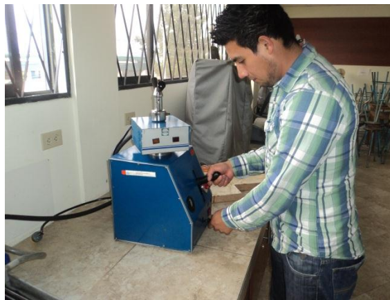
Figura 6. 46.- Montaje en caliente de la probeta
