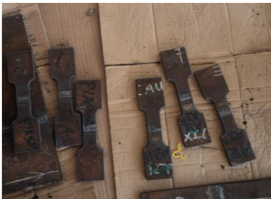
Figura 6. 15.- Probetas de 12 y 20 mm para el ensayo de tracción
