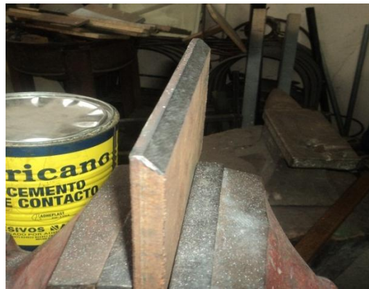
Figura 6. 34.- Biselado del material a soldar
