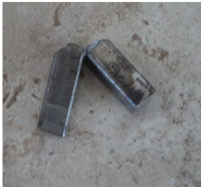
Figura 6. 31.- Probeta después del ensayo de Impacto
