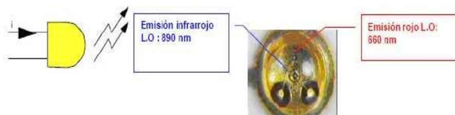
[Figura #20]: Principio de funcionamiento
