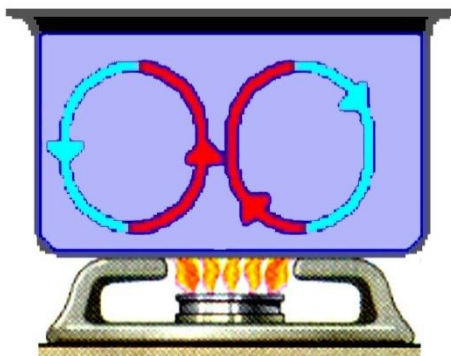
Figura 3. Transferencia de calor por convección
