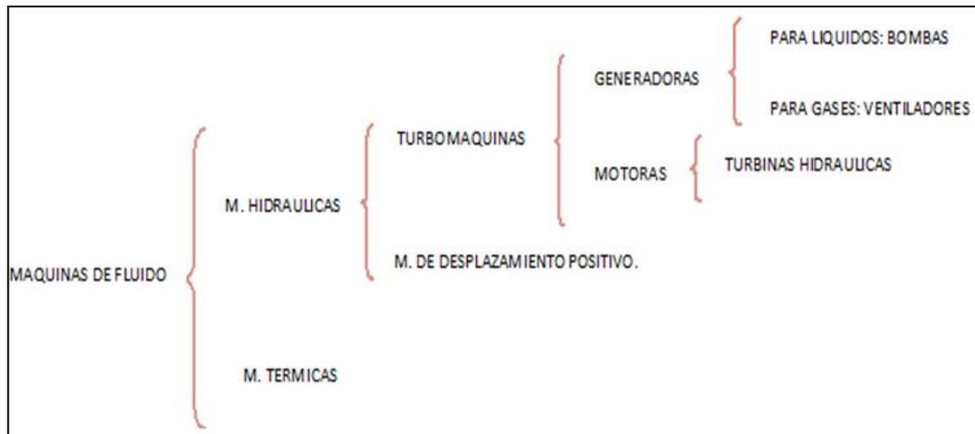
*Figura 2.2. Clasificación de máquinas de fluido.*
