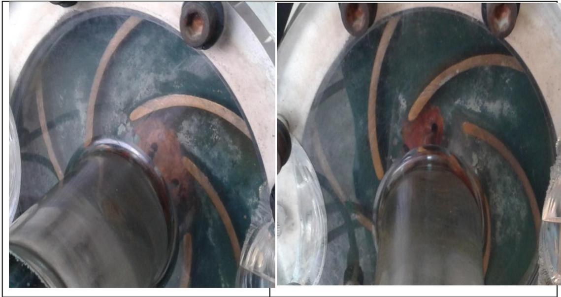
*Figura 4.12. Efecto de la cavitación en el rodete de la bomba*
