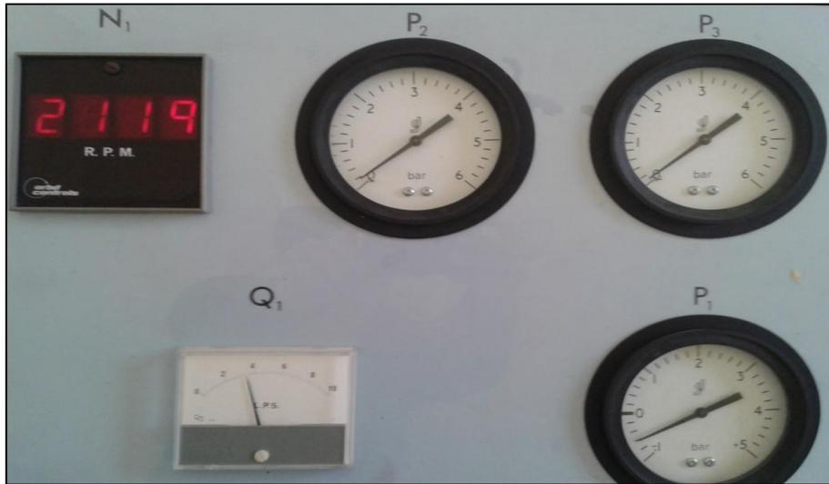
**Figura 4.11.** Lectura de los valores en el tablero de medición hidráulica cuando la válvula de succión está cerrada 60° grados.
