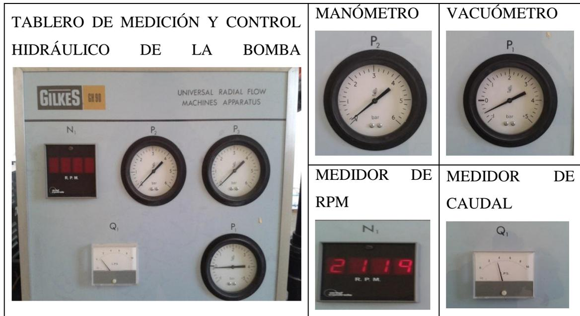
*Figura 4.3. Componentes del tablero de medición y control hidráulico de la bomba*
