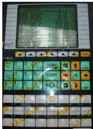
FIGURA 26.a : Controlador de Inyectora
