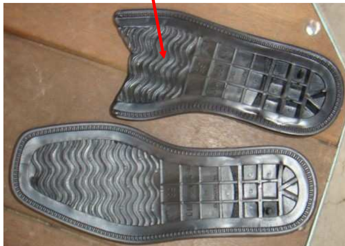
Figura 26.b: Pares Defectuosos de Suelas
