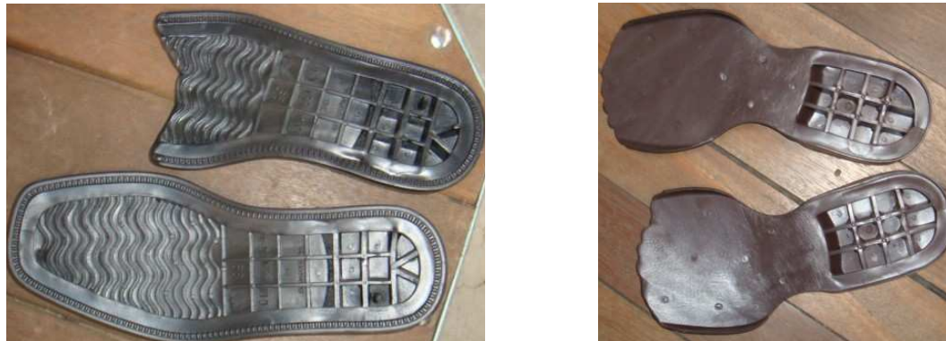
Figura 55: Suela Incompleta (Volumen de inyectora inadecuado)
