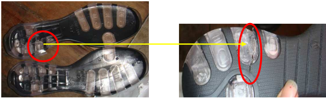
Figura 65: Suela con Rotura 1
