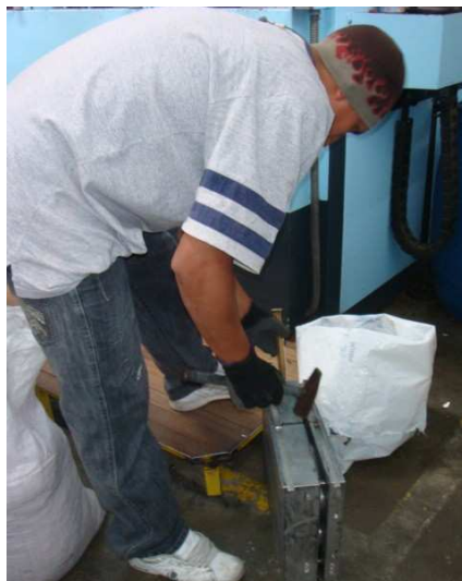
Figura 24: Seguridad del Trabajador: No utilización de Fajas de Seguridad (al transportar un molde se carga de 30 a 40 kg)
